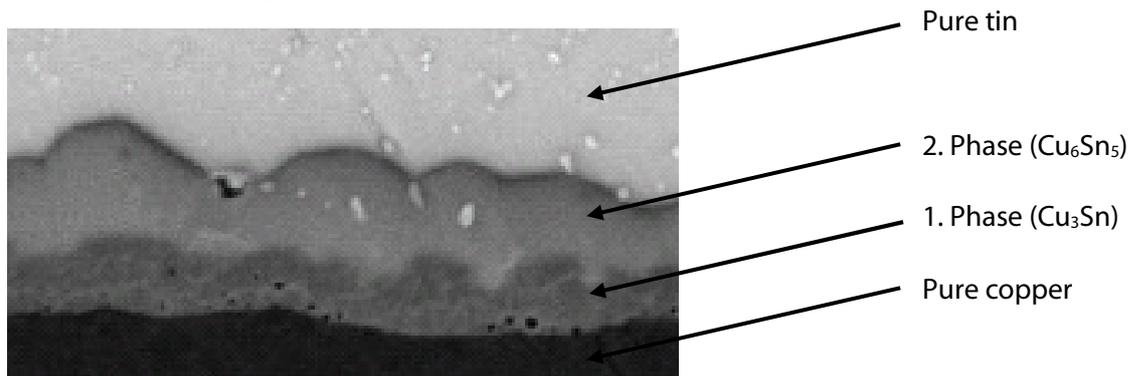
Fig. 2: Layer structure Cu/ immersion tin<sup>5</sup>
