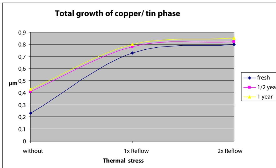
Fig. 4: Growth of diffusion layer / real time storage / thermal stress<sup>8</sup>
